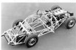
上：1957年300SLロードスター / 下：パイプフレーム構造
