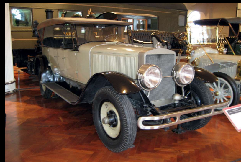
◀1925年製ダブルE20蒸気自動車。蒸気を再利用するので、水の補給は不要です。この車には、水・燃料・油の供給ポンプを動かす電気モーターと、ボイラーの燃料の制御装置も備わっています。そのうえ、ガソリンでも走れます！
