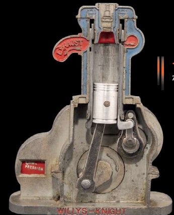
◀圧縮行程。両方のポートが閉じています。
