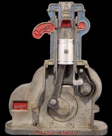
▲排気行程。吸気ポートが閉じ、排気ポートが開いています。
